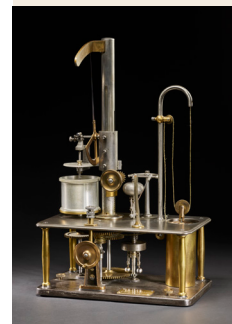
Viskosimeter, Messgerät, das in der Lebensmittelindustrie zur Qualitätssicherung von Produkten eingesetzt wird.
